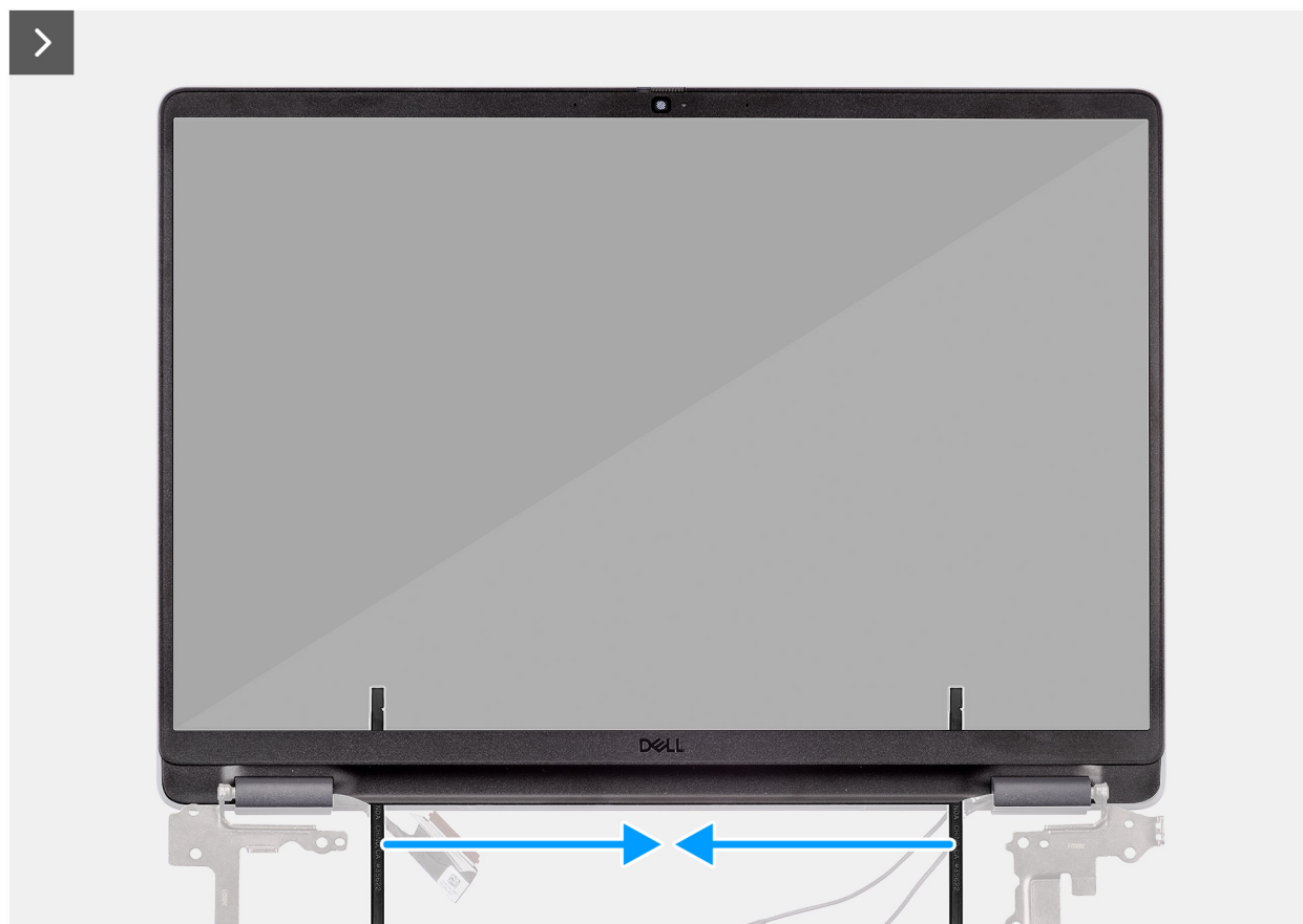
Ilustración 68. Extracción del embellecedor de la pantalla
