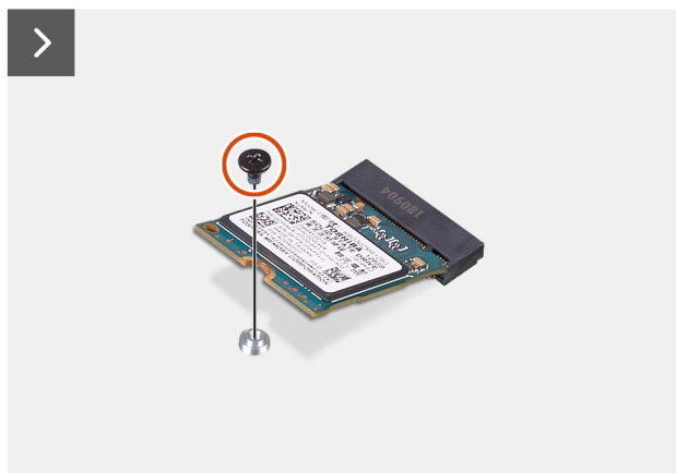
Ilustración 23. Extracción de SSD
