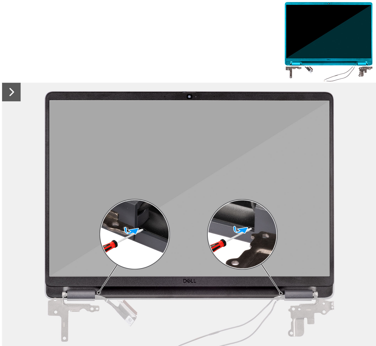
Ilustración 67. Extracción del embellecedor de la pantalla
