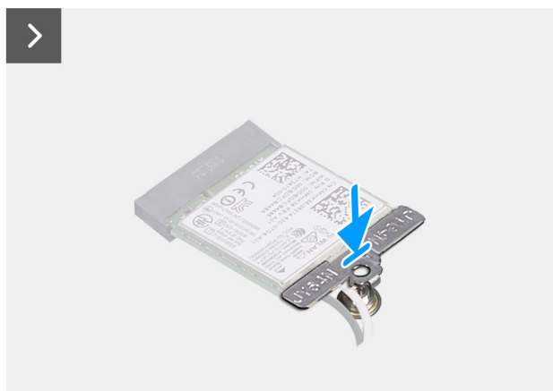
Ilustración 26. Instalación de la tarjeta inalámbrica
