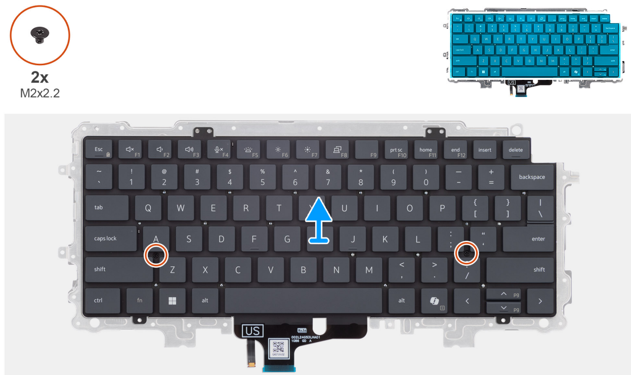
Ilustración 56. Extracción de la placa de soporte del teclado
